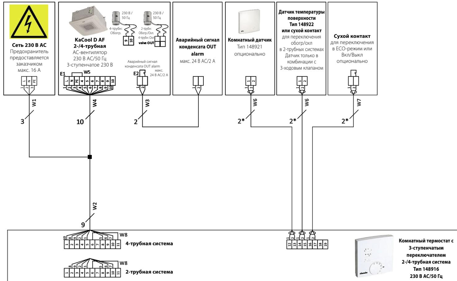
\*) Экранированный кабель 0,5 мм<sup>2</sup>, напр., J-Y(ST)Y 2 x 2 x 0,8 мм, макс. 50 м, прокладывать отдельно от силовых линий!
