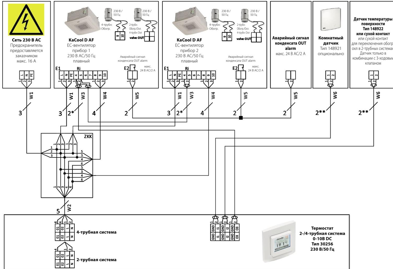
\*) Экранированный провод (например, IY(ST)Y, 0,8 мм) прокладывать отдельно от силовых линий.
