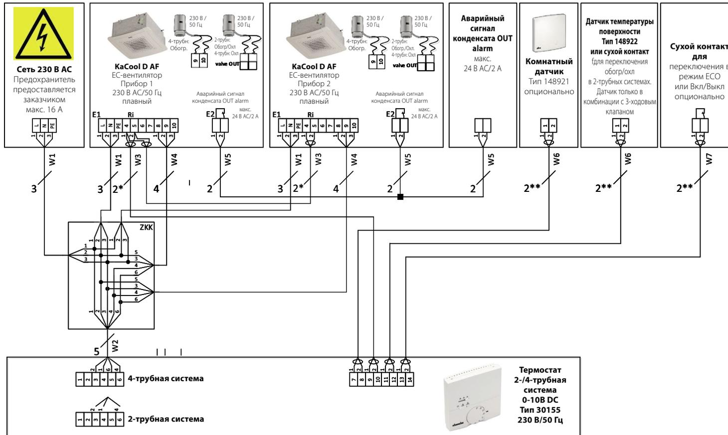
\*) Экранированный провод (например, IY(ST)Y, 0,8 мм) прокладывать отдельно от силовых линий.
