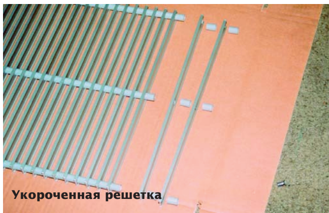
Шаг 6: Укорачивание оставшихся пружин
